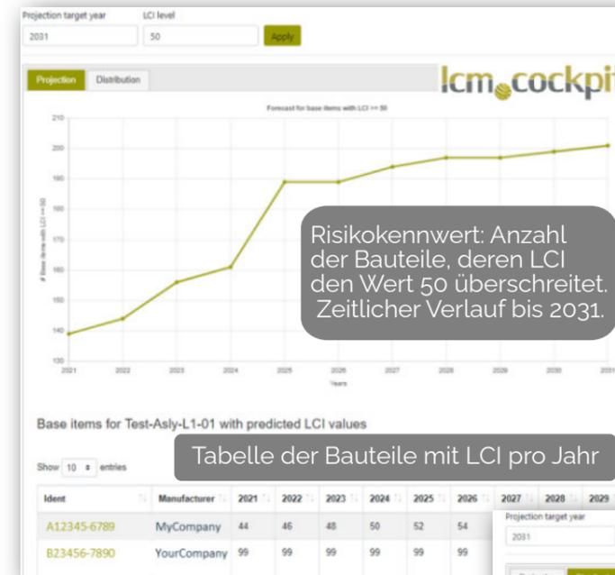
Die zweite Ansicht der Modellierung (rechts) zeigt die Verteilung der LCI Werte im Zieljahr. Die Anzahl der Kaufteile wird in Schritten von 5 LCI Werten ermittelt.
